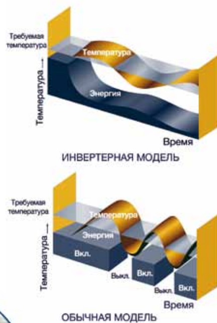
Рис. 9: Сравнение традиционного и инверторного управления
